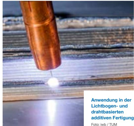
Anwendung in der Lichtbogen- und drahtbasierten additiven Fertigung
